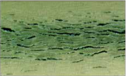
180° IT曲げ加工後、曲げ部分の顕微鏡拡大写真撮影
