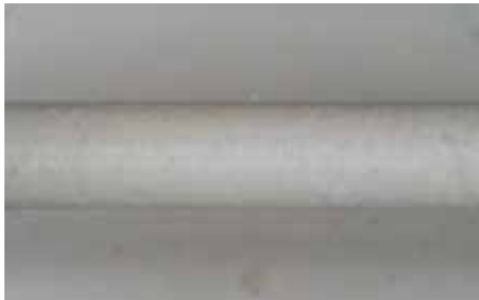
塩水噴霧試験 試験時間：2000時間 180° IT曲げ
