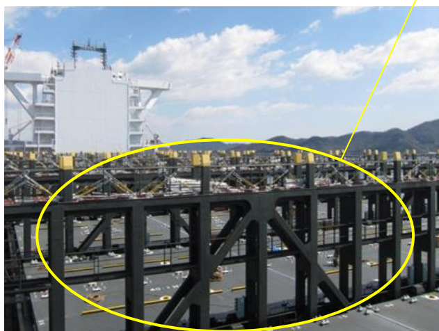
③ 角形鋼管の適用事例(甲板上設置されたラッシングブリッジ)
