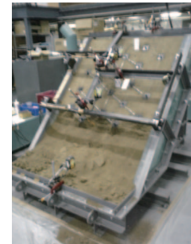
耐震性を確認する、振動台実験
