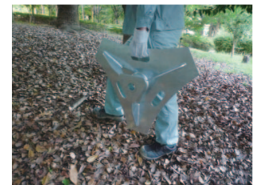
「とって」加工により、急斜面での施工性が向上しました。
