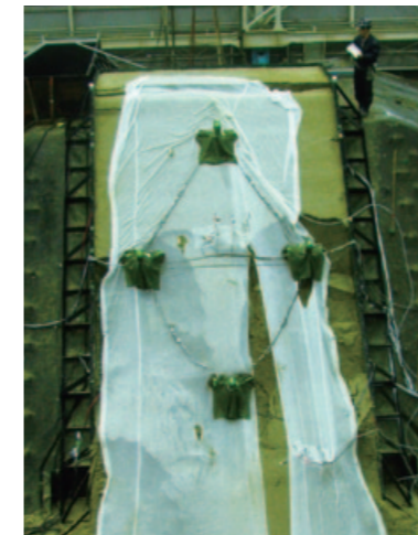
実物大斜面による降雨実験
