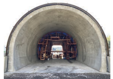
▲自己充填覆工構築システム実規模実験
